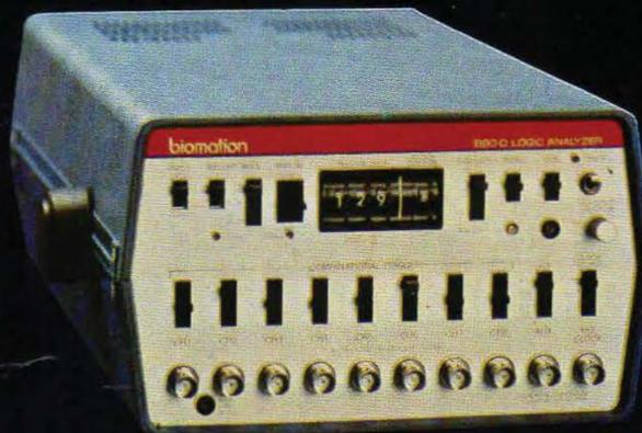
Il modello 920-D è il più economico Logic Analyzer a 20 MHz, 9 canali, 256 bits per canale, latch mode, trigger combinatoriale su tutti i canali ed è particolarmente adatto per il SERVICE dei circuiti digitali.
